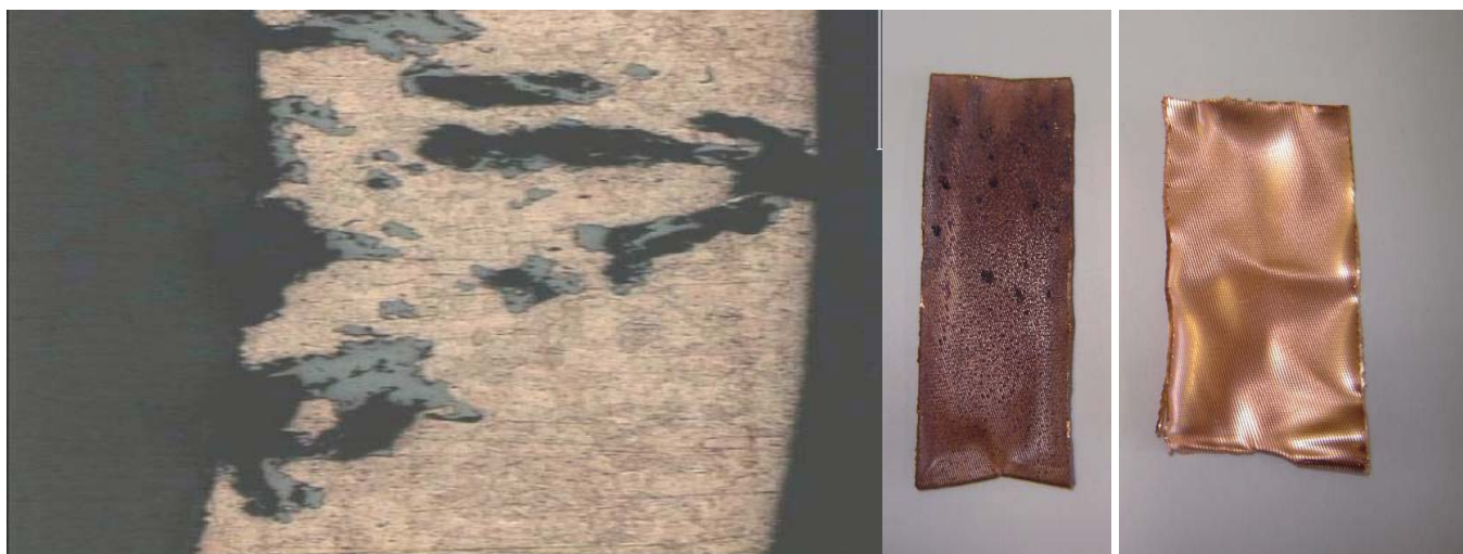
Рис. 3. Исследование среза трубы электронным микроскопом: слева — коррозия, справа — нет коррозии.
